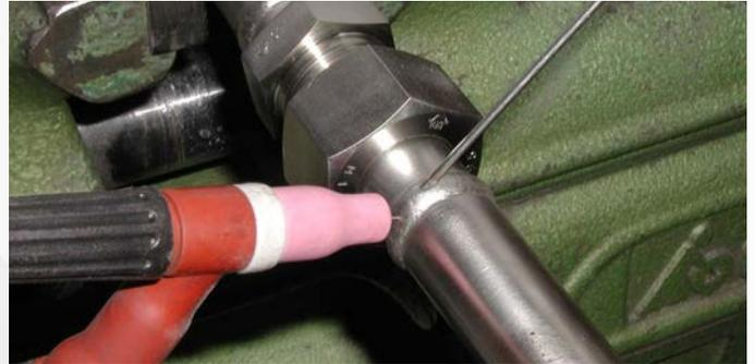
4. Überwurfmutter lösen und Rohranschlüsse fertig schweißen. Auf Minus-Pol achten.
