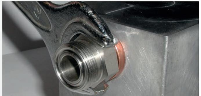
11. Zur Abdichtung des Einschraubzapfens gegenüber Gehäuse oder Block empfehlen wir den Einsatz von Weichmetalldichtungen nach DIN 7603.
