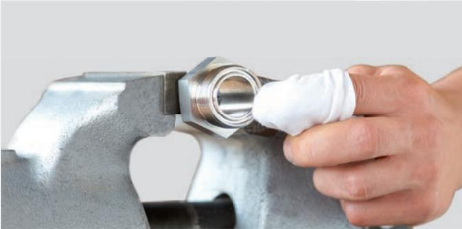
7. DILO-Nut und -Feder vor Zusammenbau reinigen.
