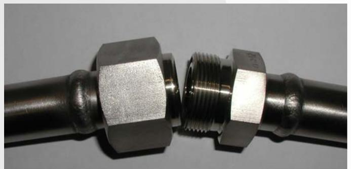
6. Falsch: nicht fluchtend verschweißt - führt zu Undichtigkeiten
