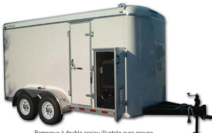
Remorque à double essieu illustrée avec groupe électrogène diesel 35 kW en option
