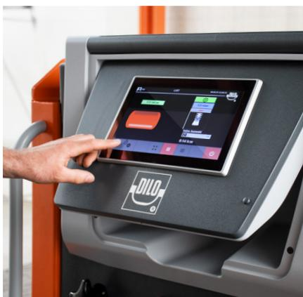
Operación, indicación de los parámetros de proceso importantes e ilustración del flujo de gas seleccionado en el panel táctil. Las unidades de indicación (p. ej., bar/mbar/kg) se pueden seleccionar directamente en el panel.
