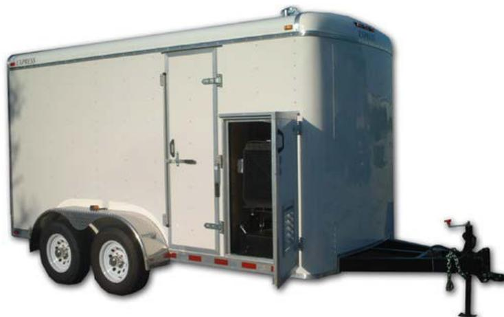
Se muestra el tráiler de doble eje con grupo electrógeno diésel opcional de 35 kW
